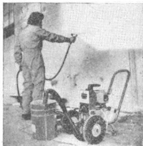
Fig. 117. Agregat mobil de pulverizare fără aer cu două etaje de pompare hidraulică cu recipient pentru compoziția de vopsit separat (ambalaj original).
