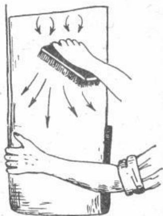
Fig. 186. Netezirea fișiei de tapet, aplicate pe perete.
