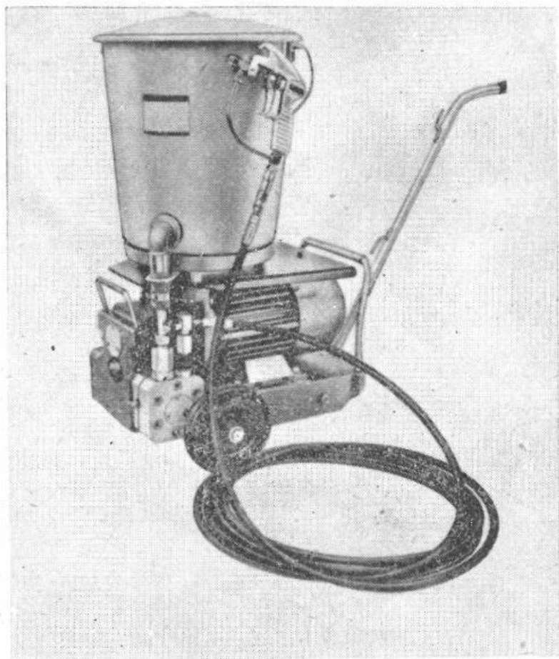
Fig. 118. Agregat mobil de pulverizare fără aer cu două etaje de pompare hidraulică, fără pompă de absorbție-refulare și cu recipient propriu pentru compoziția de vopsit, fixat deasupra agregatului.
